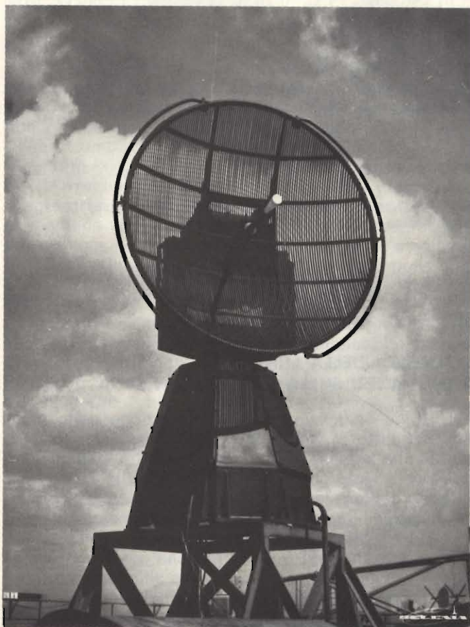
Fig. 6 - Antenna per il radar meteorologico Meteor 200 RMT di costruzione italiana (Selenia).
